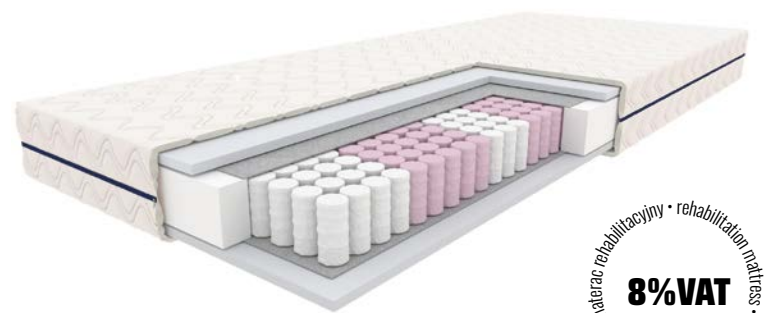
Jadeit 90 200 120 200 140 200 160 200 materac rehabilitacyjny / rehabilitation mattress / реабилитационный матрас wkład: sprężyny kieszeniowe 7-strefowe (ok 200 sprężyn na m 2 ) - 15 cm, przekładka tapicerska, pianka komfortowa (gęstość ok. 25 kg/m 3 ) - 2 cm, pokrowiec: tkanina Tender (100% poliester) pikowany owatą antyalergiczną o gramaturze 120 g/m 2 , zamek rozdzielczy, wysokość: około 20 cm, twardość: 3/5 input: 7-zone pocket springs with spacers - 15 cm, comfort foam - 2 cm, cover: Tender fabric (100% polyester) fabric quilted with antiallergic non woven with a weight of 120 g/m 2 , distribution zipper, height: about 20 cm, hardness: 3/5 наполнение: пружины карманного типа - 15 см, комфортная пена - 2 см, чехол: Tender ткань (100% полиэстер) ткань простегана антиаллергенным нетканым материалом плотностью 120 г/м 2 , застежка-молния, высота: около 20 см, жесткость: 3/5
